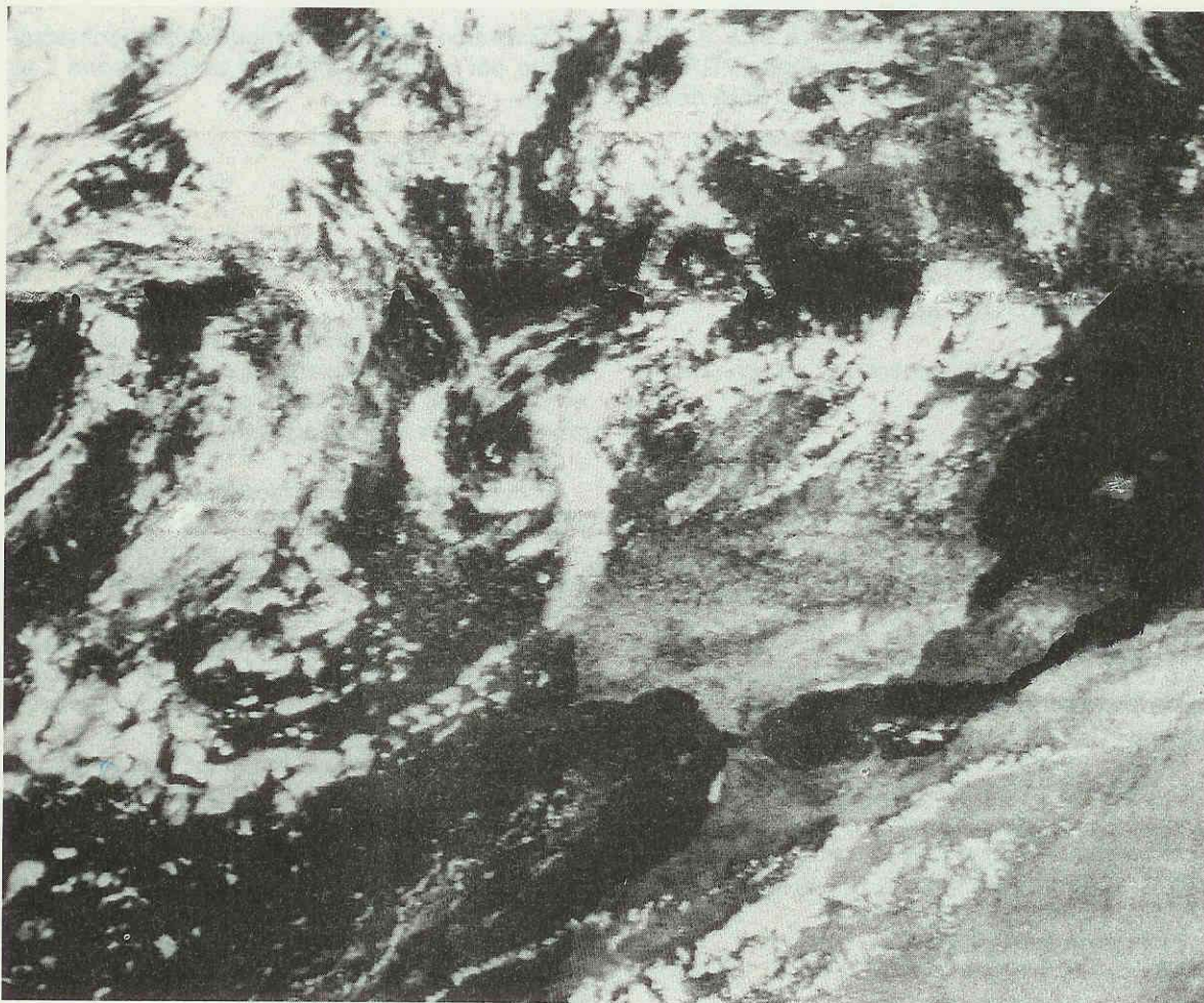
Fig.26 Un'immagine della penisola Iberica (vedi stretto di Gibilterra) trasmessa dal satellite russo MET2.17 sulla frequenza di 137.300 MHz. Attualmente i satelliti russi che trasmettono regolarmente sono il MET3.3 (frequenza 137.850 MHz), il MET2.17 e saltuariamente un satellite "nuovo" (vedi fig.13) sulla frequenza di 137.400 MHz.
