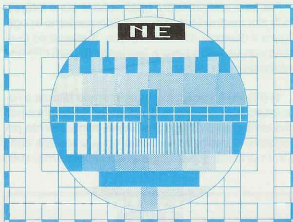
Fig.8 Se la barra nera visibile nella parte superiore del monoscopio e utilizzata per scrivere il nome della emittente (vedi N.E.) presenta delle ombre, significa che la risposta video alle frequenze più basse non è corretta.
